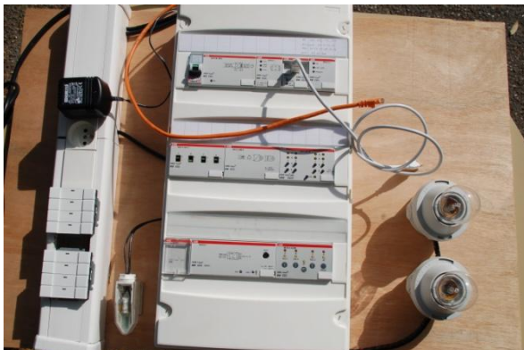
Maquette orientation matériel ABB Avec module commande DALI et module alarme
