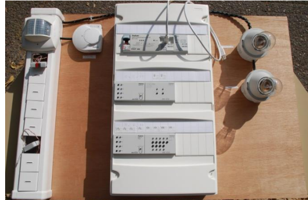
Maquette orientation matériel THEBEN Avec thermostat et commande de chauffage
