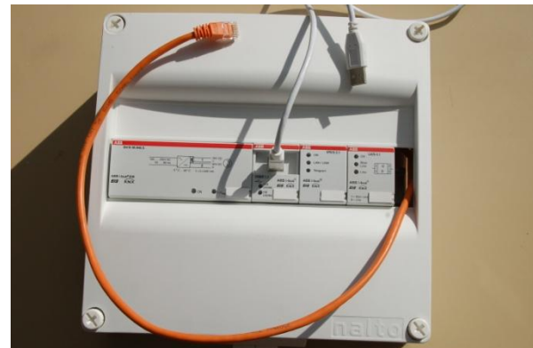
Maquette orientation matériel ABB dorsale Avec coupleur IP et coupleur Zone
