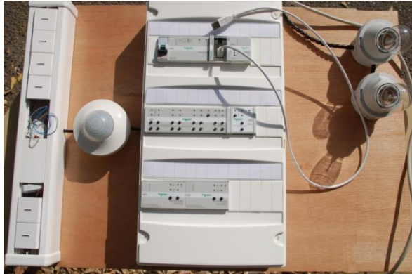
Maquette orientation matériel SCHNEIDER Avec détection présence/luminosité et module logique
