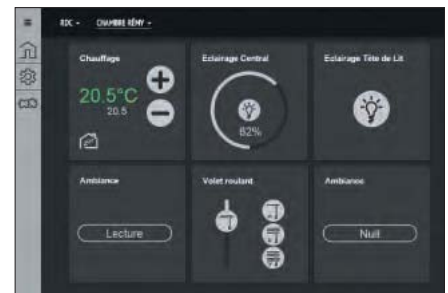
Vue simplifiée et configurée avec l'app "Touch" ou eConfigure KNX
