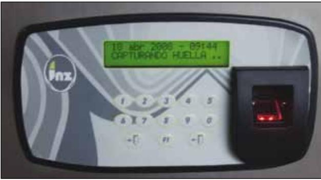
Figure 4. Grâce à l'interface du système de contrôle d'accès (empreinte digitale) au système KNX, un contrôle personnalisé de tous les systèmes est possible.
