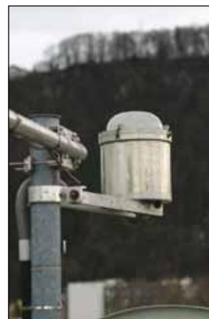
Figure 2. Le récipient de mesure avec les capteurs de lumières.
